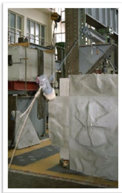
Slika 58 Preskusna metoda odpornosti plezalne plošče (Srpčič, b.d.)
