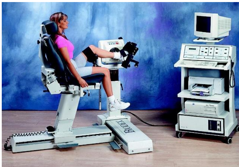
Slika 98. Prikaz naprave s katero izvajamo izokinetične treninge in meritve za mišice skočnega sklepa (pridobljeno 15.12.2010, z http://physiotuam.ie/pages/treatment.php )
