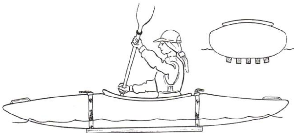
Slika 16. Povečanje stabilnosti z namestitvijo lesenih letvic (Smedley, 1995).
