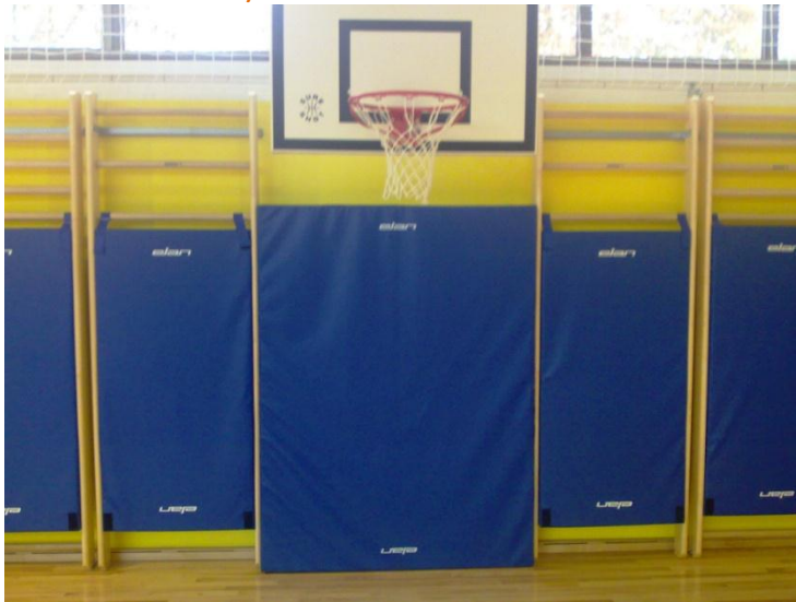
Slika 5. Primer zaščite letvenikov z blazinami in zaščite naletne površine za malim košem z debelo blazino (istočasno skladišče za to blazino)
