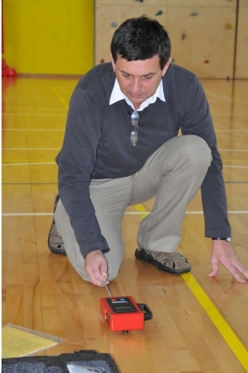
Slika 2: Prikaz meritve in merskega pripomočka za merjenje drsnosti športnega poda
