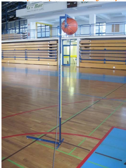
Slika 3: Naprava za preiskavo navpičnega odboja žoge in prikaz značilne meritve
