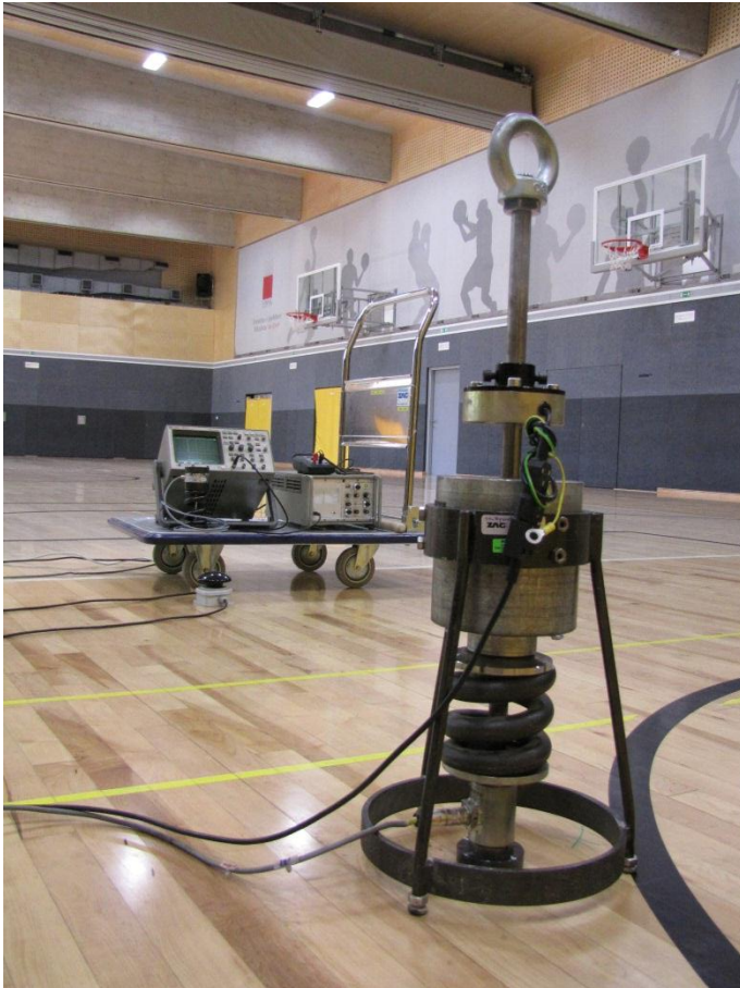
Slika 2: Naprava za meritev ublažitve udarca (umetni športnik)
