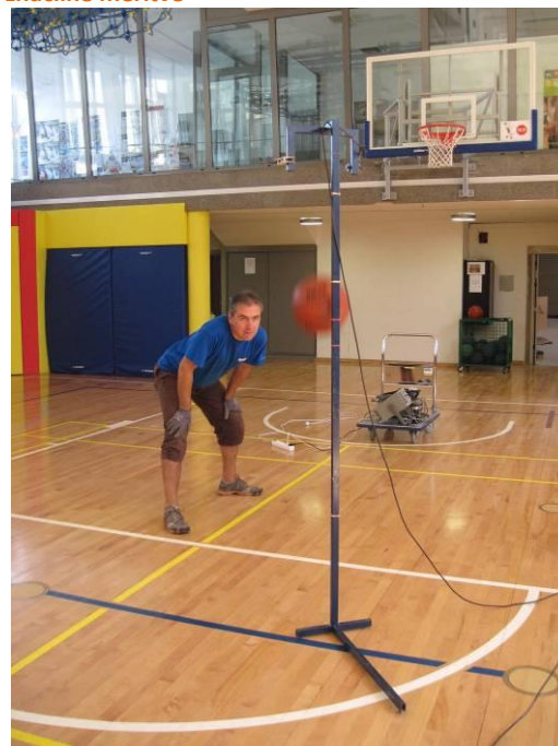
Prikaz 35: Naprava za preiskavo navpičnega odboja žoge in prikaz značilne meritve
