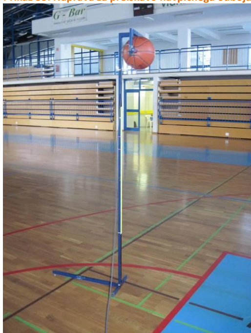
Prikaz 35: Naprava za preiskavo navpičnega odboja žoge in prikaz značilne meritve
