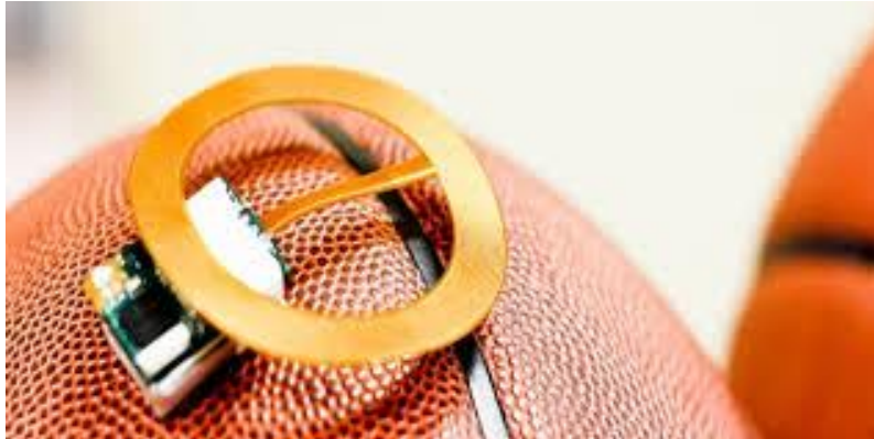
Slika 15: Vztrajnostni senzor za zaznavanje gibanja, ki je nameščen znotraj 94Fifty (© Infomotion Sports Technologies) žoge (Sensor in 94Fifty ball, 2014)
