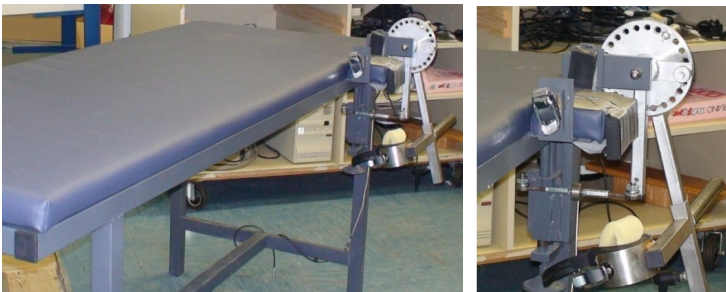
Slika 13. Opornica za merjenje navora pri iztegovanju komolca.
