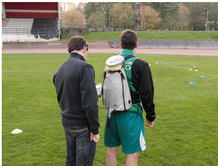
Slika 5: RTK GNSS sprejemnik, zapisovalnik podatkov in antena v majhnem nahrbtniku.
