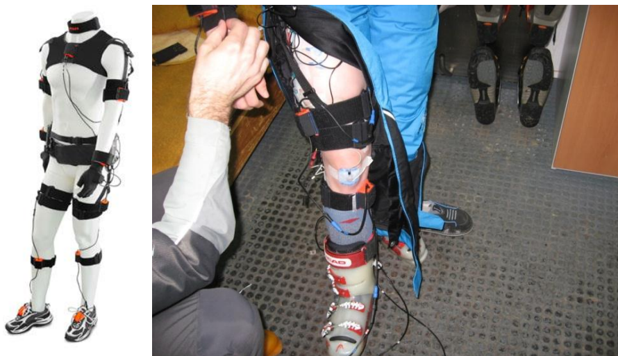
Slika 14. Primer tipa obleke s sistemom inercialnih senzorjev, s katero smo izvajali meritve (levo) in nameščanje sistema na merjenca pred meritvijo (desno).
