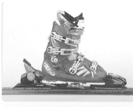
Slika 11. Prikaz podložne plošče med smučko in vezjo. Zaradi podložne plošče na smučki pod smučarskim čevljem se poveča stojna višina, s čimer se zmanjša verjetnost nasedanja čevlja na sneg pri velikih nagibih v zavoju.
