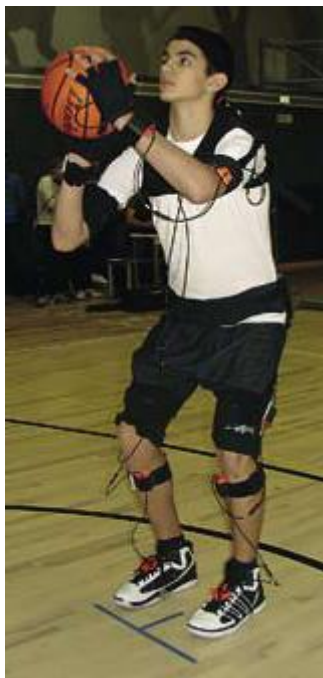
Slika 8. Merjenec, oblečen v inercialno obleko MVN.
