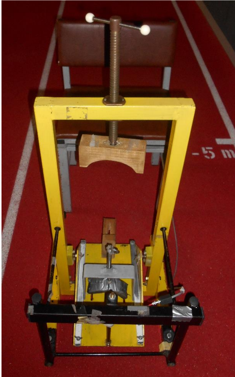
Slika 16. Upornica za izometrične meritve stopala (plantarna in dorzalna fleksija)
