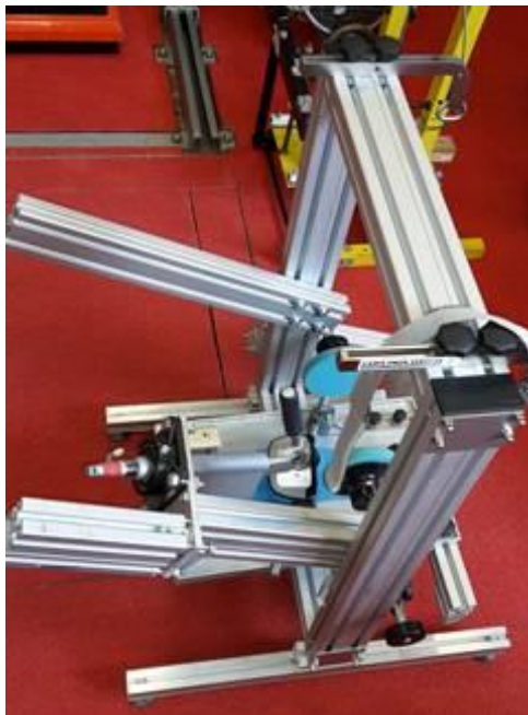
Slika 14. Upornica za meritve izometričnih gibov stopala (inverzija, everzija, zunanja rotacija in notranja rotacija)
