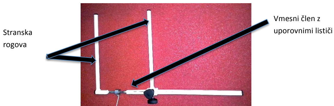
Slika 3. Naprava za merjenje lateralne sile v predelu zunanjšega kvadranta trebuha (osebni arhiv)
