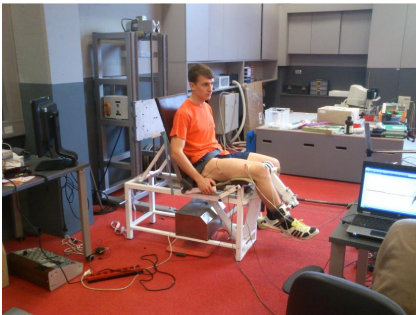
Slika 1. Meritev v izometrični opornici za iztegovanje kolena
