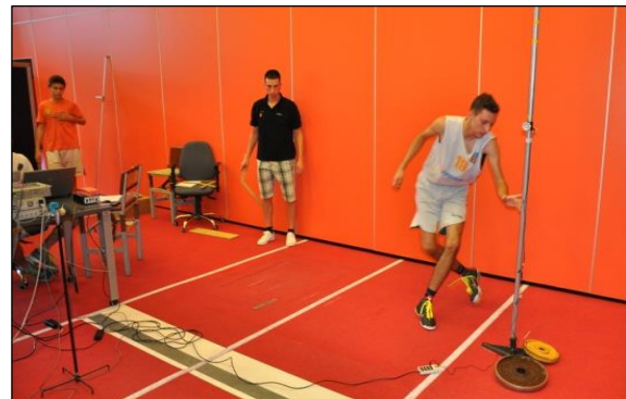
Slika 9. Dotik stojala s pospeškometerom (osebni arhiv).
