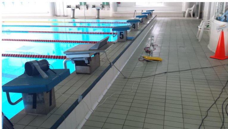
Slika 6. Tenziometrijska plošča pod startnim blokom (lasten arhiv).
