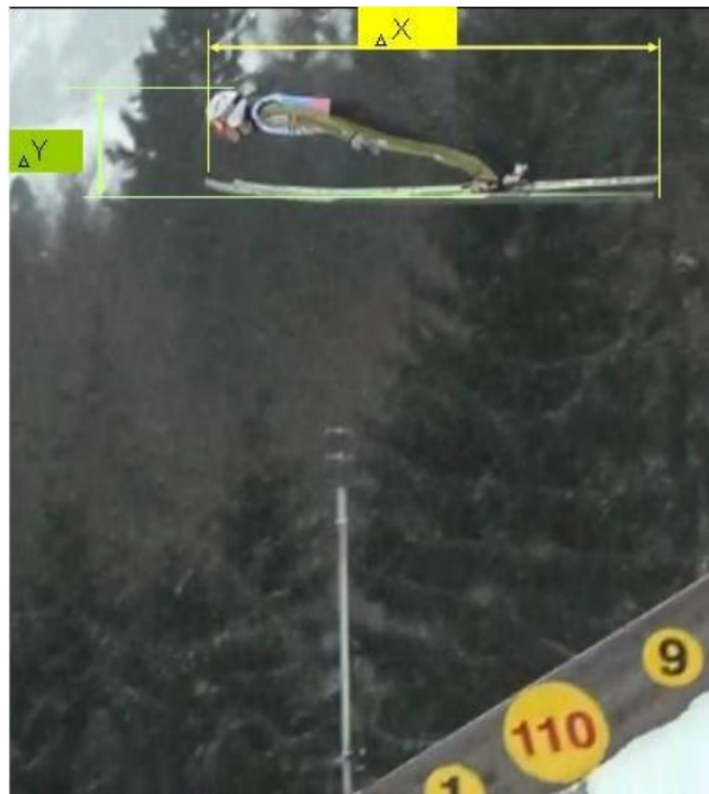
Slika 6: Prikaz vodoravne in vertikalne razdalje uporabljenih pri izračunu aerodinamičnega indeksa leta (Jošt, Ulaga in Vodičar, 2013).
