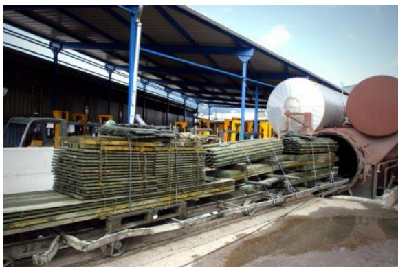
Slika 7. Zaščita lesa v podjetju Imont d.o.o. (Kemična zaščita lesa, 2014).
