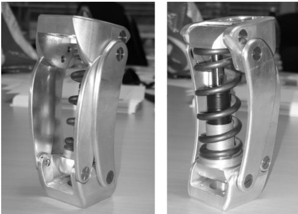
Slika 18: Prototip športnega kolena (Demšar idr., 2011)
