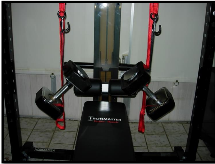
Slika 11: Primer tehničnega varovalca z vpetimi ročkami na vrvi (osebni arhiv).
