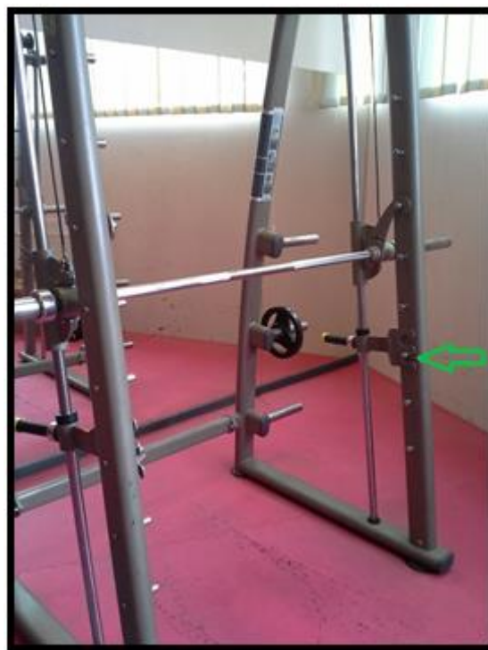
Slika 4: Izboljšano tehnično varovalo na vadbeni napravi Smith (osebni arhiv).
