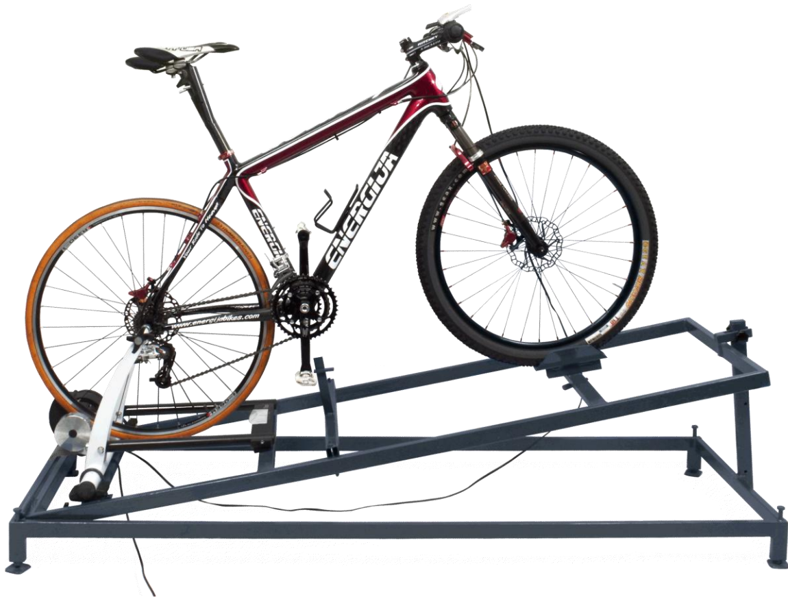
Slika 5: Železna platforma, ki simulira naklon in v katero je vpet kolesarski ergometer in kolo. V kolo je vstavljena tudi NSO.
