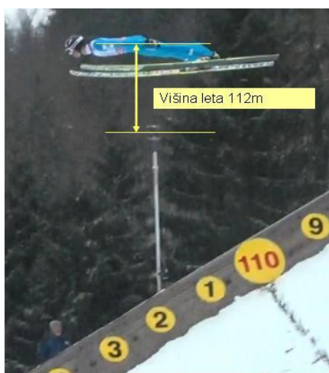
Slika 2: Metoda za izmero spremenljivke višina krivulje leta v točki oddaljeni 112 metrov od roba odskočne mize (povzeto po Joštu, Ulagi in Vodičarju, 2013)
