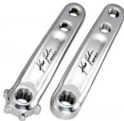
Slika 45: Edinstveno zasnovane gonilke z dvema luknjama za pedal in nosilcem za disk (KH Dual Spirit, 2013)
