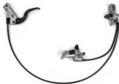
Slika 40: Med monokolesarji najbolj priljubljena magura hidravlična zavora HS-33, primerna za gorsko monokolesarjenje (Magura HS-33, 2013)
