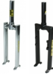
Slika 39: QU-AX CrMo okvirja s pravokotno oblikovano krono vilic (QU-AX okvirji CrM, 2013)
