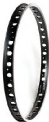
Slika 42: 26" izredno močan obroč z dvojnimi dnom ter ovalnimi vmesnimi luknjami za varčevanje pri teži; narejen za gume z velikim volumnom (KH 26" Freeride, 2013)
