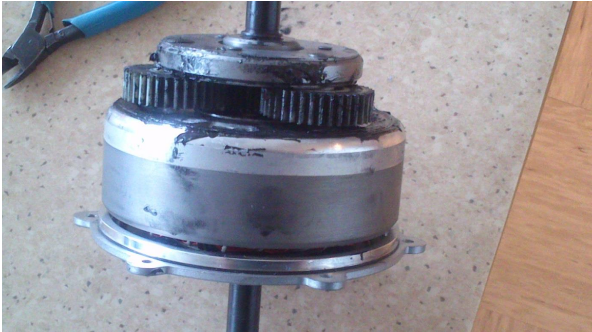
Slika 7. Notranjost električnega motorja oziroma generatorja (osebni arhiv)
