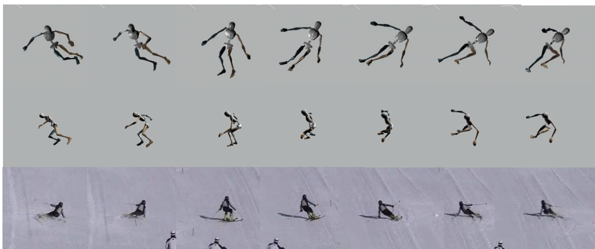
Slika 15: Položaji smučarja, prikazani kot model MVN-obleke in primerjava z video posnetkom (Supej, 2011)
