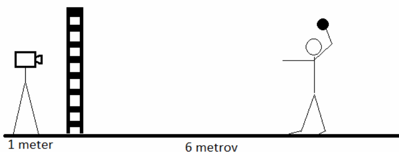
Slika 6: Prikaz postavitve radarja in merjenca v narisu.
