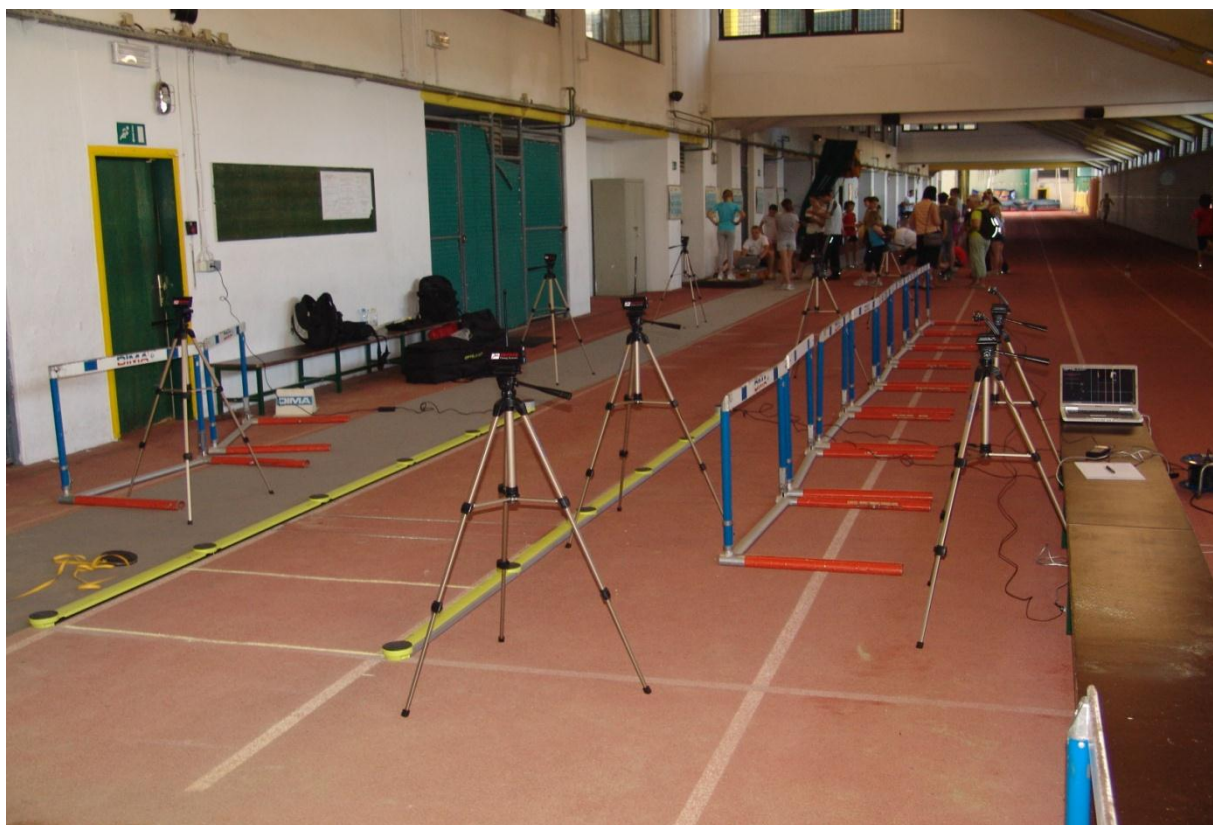
Slika 12: Postavitev merilnih instrumentov na zaletišču za skok v daljino
