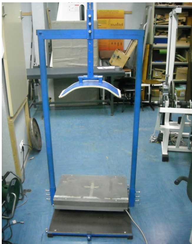
Slika 4: specialna merilna naprava za diagnostiko izometrične moči smučarjev skakalcev v počepu (avtor naprave B. Jošt).
