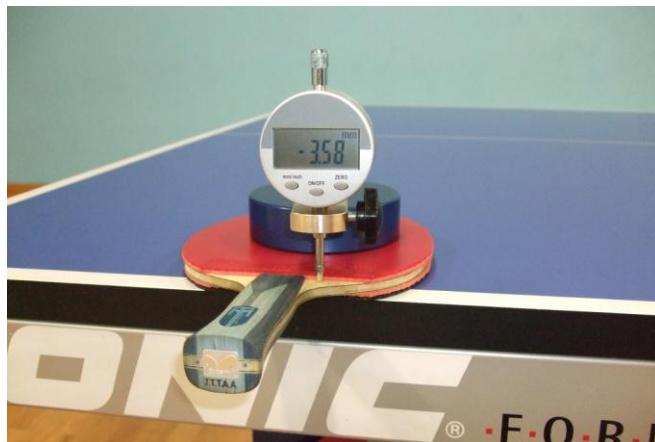
Slika 25: Naprava s katero se meri debelina obloge
