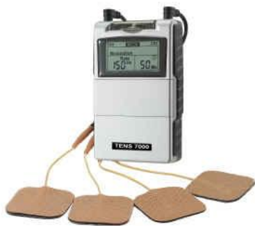
Slika 4: Primer naprave za električno stimulacijo mišice: TENS (Tens Unit, 2010)
