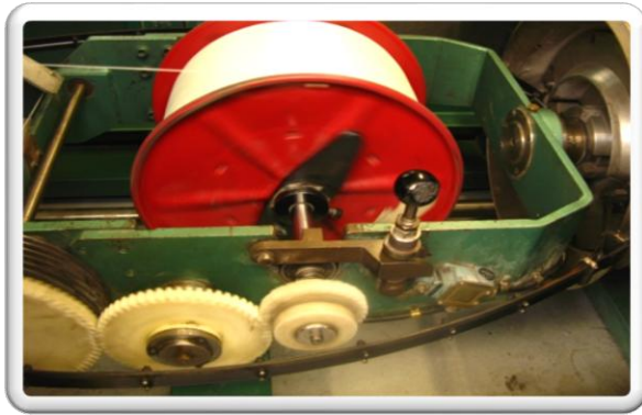
Slika 19: Naprava v fazi torzije (Lougoes, 2010)
