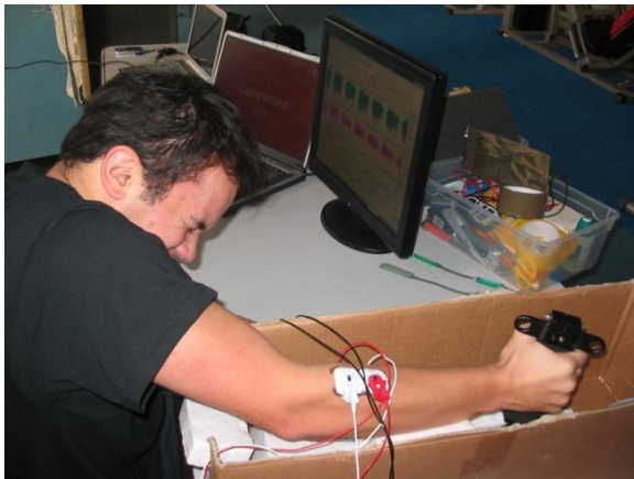
Slika 30: Prikaz merjenja moči stiskanja naprave (Fabre in Blary, 2010)
