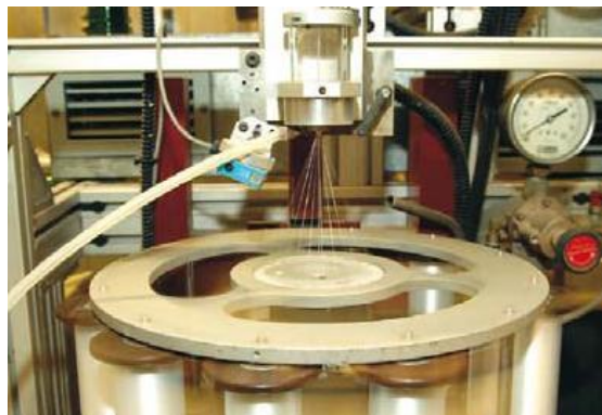
Slika 14: Prikaz naprave, kjer iz mikrovlaknen naredijo struno (Lougoes, 2010)
