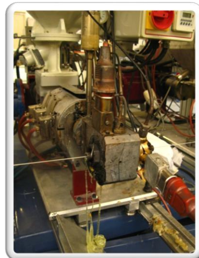
Slika 22: Naprava, kjer struno spolirajo in premažejo (Lougoes, 2010)
