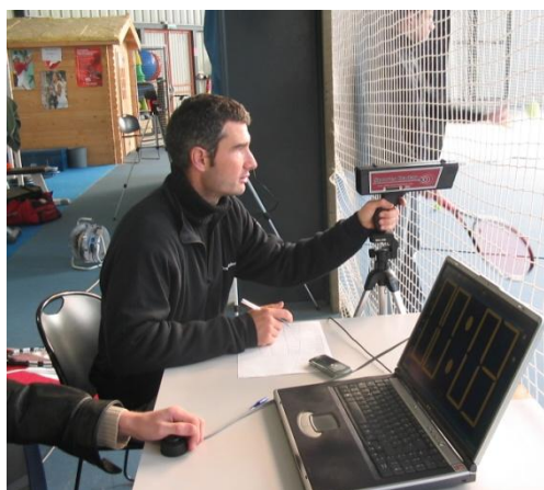
Slika 32: Merjenje hitrosti žog z radarsko napravo med igro (Fabre in Blary, 2010)
