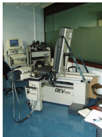
Slika 8. Izokinetični dinamometer Technogym – REV 9000 (osebni arhiv).
