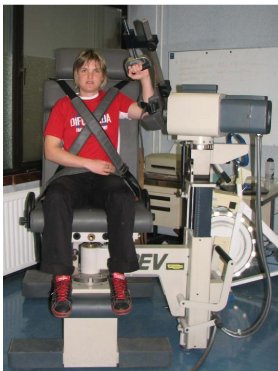
Slika 10. Namestitev merjenca na dinamometer (osebni arhiv).
