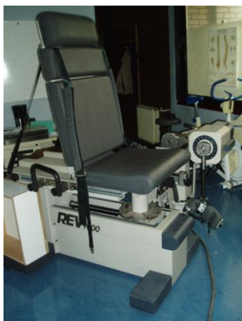
Slika 8. Izokinetični dinamometer Technogym – REV 9000 (osebni arhiv).
