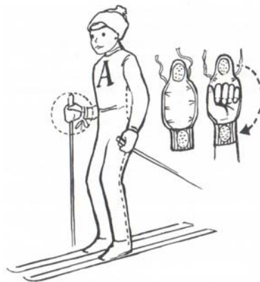
Slika 1 – Prilagojena smučarska rokavica za otroke, ki sami ne morejo držati palice (Ducommun, 2005)
