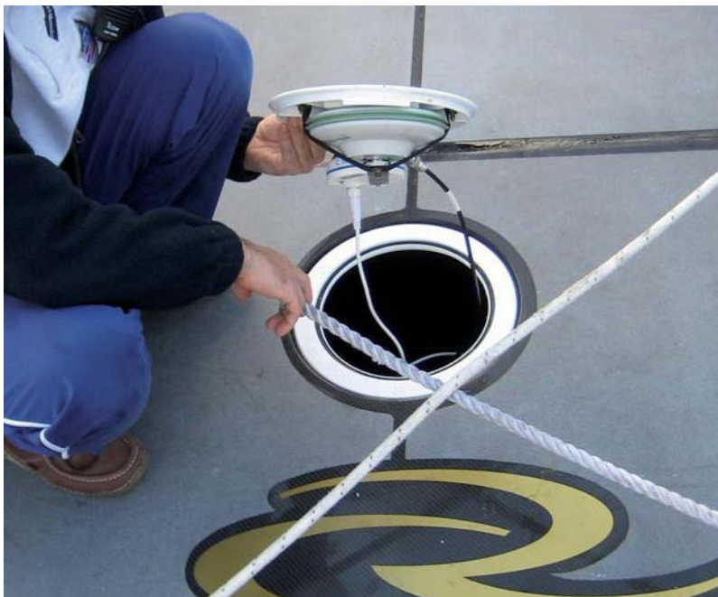
Slika 17: Prikaz postavitve GPS/GLONASS antene pod pokrov jadrnice za sprejem podatkov (Supej in Bilban, 2008).
