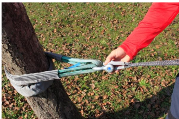
Slika 6. Konec najlonskega traku s tovarniško zašito zanko vpet v pritrdilno točko (foto: Lucija Odar, 2011).
