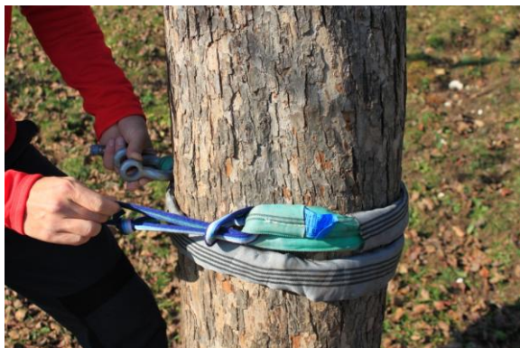
Slika 5. Kavbojski vozel za podaljševanje zank ni najbolj priporočljiv (foto: Lucija Odar, 2011).
