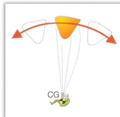
Slika 38. Stabilnost okoli prečne osi (Glušič, 2003).
