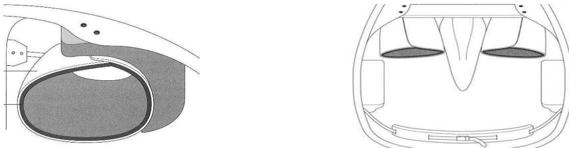
Sliki 24 in 25: Prikaz sistema, ki omogoča držo štrclja amputirane osebe pripomore k zagotovitvi dodatne stabilnost pri veslanju (Zeller, 2009).
