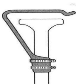
Slika 34: Sistem ABS za boljši prijem kanuističnega vesla (Zeller, 2009).
