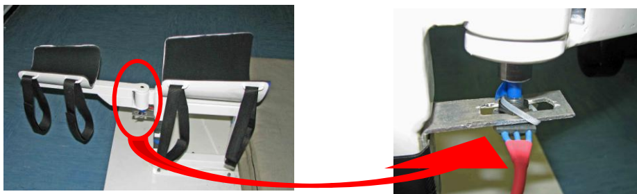
Slika 7: Opornica za sledenje kota in detajl električnega kotomera.
