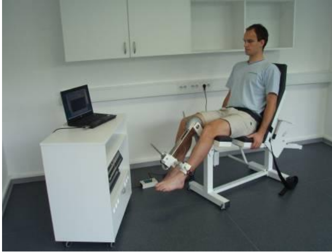
Slika 10: Postavitev merjenca v opornico za sledenje sile
