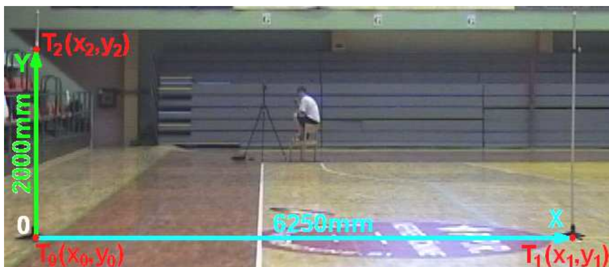
Slika 11: Kalibracijski video posnetek DV mini kamera JVC s prikazom mer za preračuna merilne skale.
