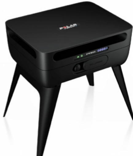
Slika 3. Univerzalni sprejemnik, ki lahko sprejme informacije do 20 oddajnikov naenkrat.
