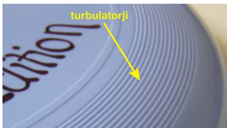
Slika 22: Turbulatorji na zgornji površini blizu roba frizbija
