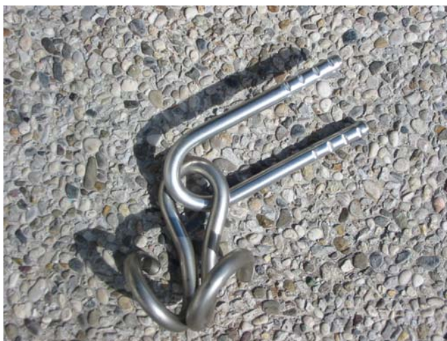
Slika 12: »Prašičji repek« na dvotočkovno lepljenem svedrovcu
