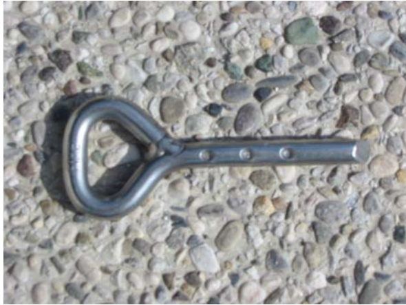
Slika 5: Glava in telo lepljenega svedrovca
