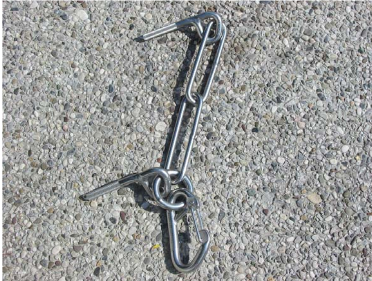
Slika 11: Dvotočkovno lepljeno sidrišče z vponko
